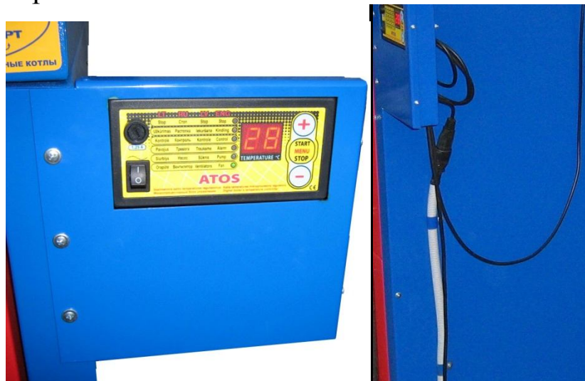
Рисунок 5 – Установка блока управления
