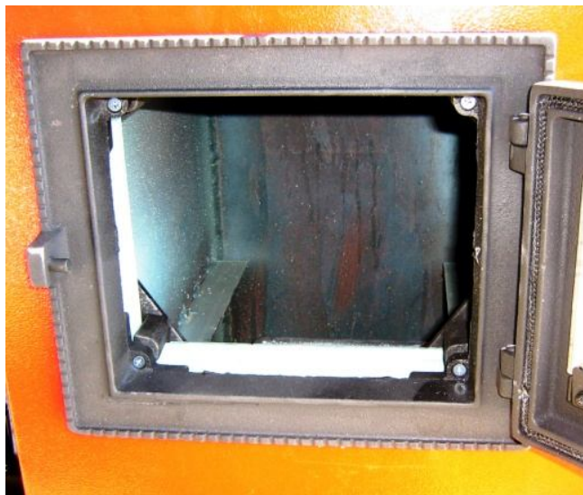
Рисунок 2 – Топочная дверка котла СТАРТ-30
