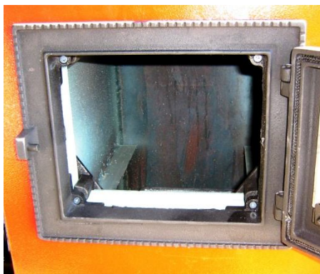
Рисунок 5 – Топочная дверка котла
