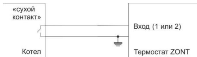
Выходной контакт аварийного разъема подключаемого котла имеет тип «сухой контакт». Допускается прямое подключение к входу термостата.
